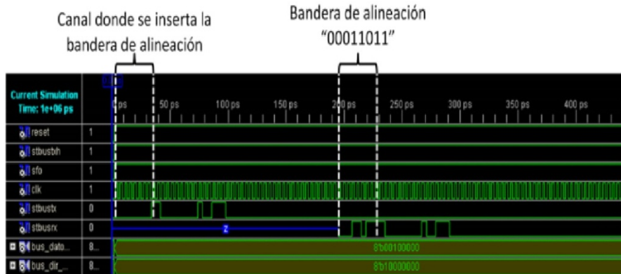
Fig. 9. Simulación de la interfaz con el microprocesador MEMORM3.
