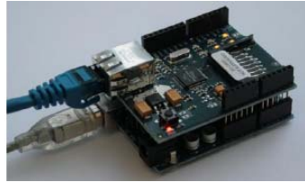
Fig. 1. Arduino con módulo EthernetShield
